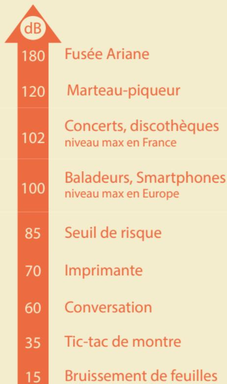
Le **VOLUME** correspond à l'intensité sonore. Il se mesure en **décibels (dB)**. Ils ne s'additionnent pas de façon arithmétique, mais selon une progression logarithmique.
